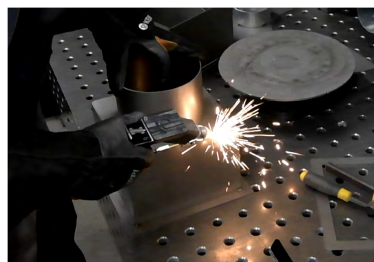
La soudure laser permet de traiter des pièces uniques aux angles multiples.
