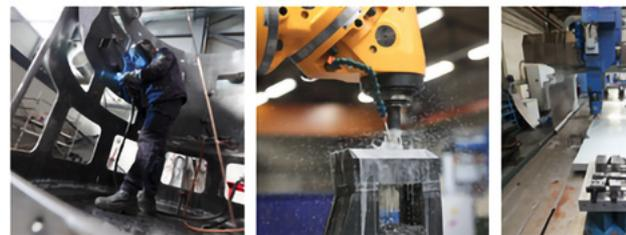
L'équipement de notre atelier nous permet de travailler des épaisseurs de 10 à 120 mm et de manutentionner des constructions mécano-soudées jusqu'à 16 tonnes.
