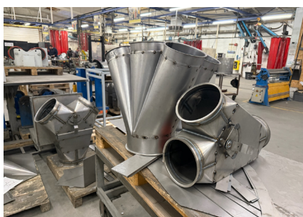
Un exemple de pièces travaillées par les chaudronniers pour s'entraîner.
