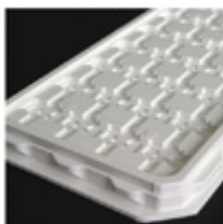
Plateau technique automobile pour utilisation sur ligne entièrement automatisée. Modèle thermoformé en PS noble d'épaisseur 4mm et réalisé avec une celerure périphérique d'empilage
