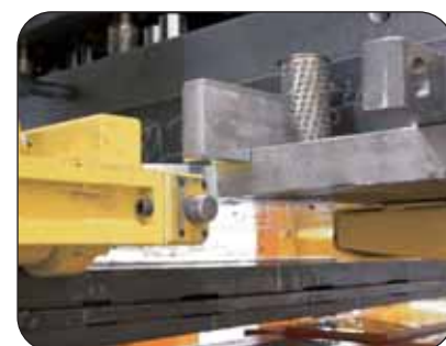
Système d'accrochage à baionnettes. Accrochage de l'outil en temps masqué dans le rack de stockage.
