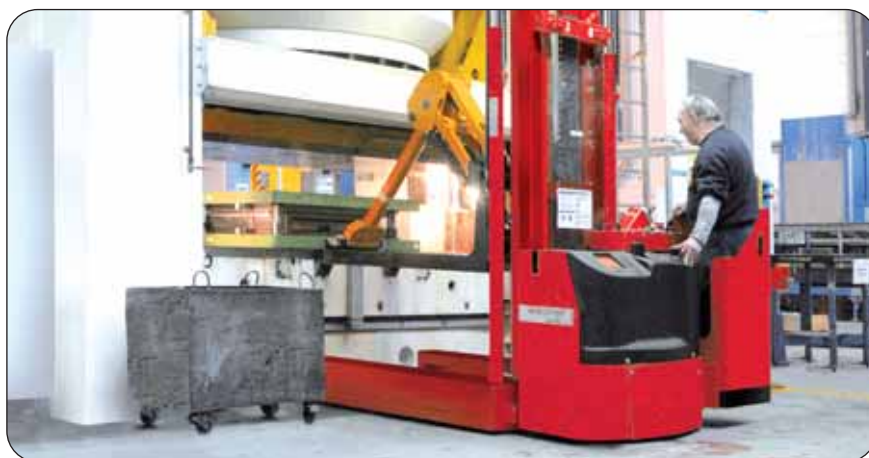
Changement d'outil sur presse hydraulique 6000 tonnes, équipée d'un système de bridage magnétique des outils Rotobloc-PSP
