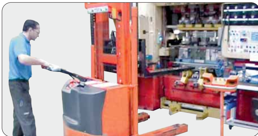
Changement d'outil sur presse mécanique de 120 tonnes, équipée d'un système Rotobloc-PSP de bridage hydraulique pour outil.
