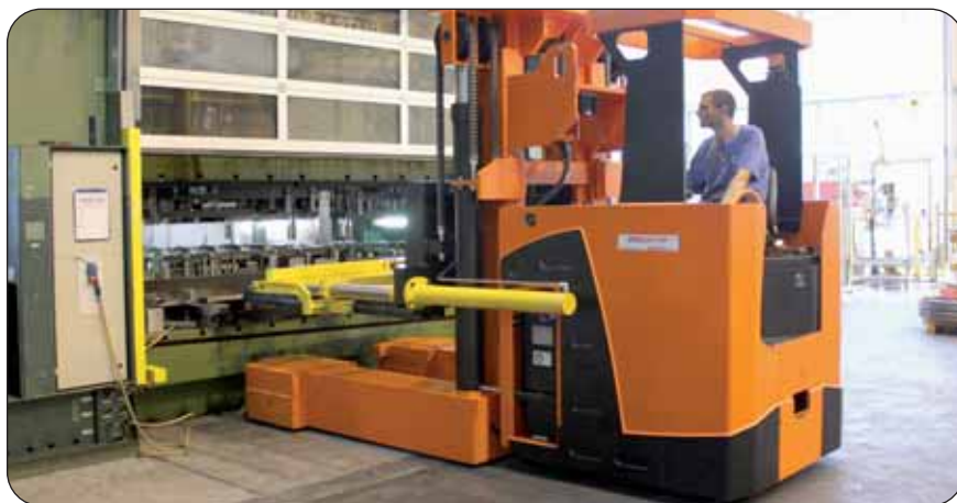
Chargement d'outil sur presse mécanique 1000 tonnes
