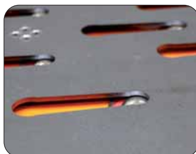
Billes inactives permettant un transport sécurisé de l'outil
