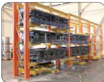
MAXI-CANTIBLOC® capacité total 37,5 tonnes (12,5 tonnes par outil)
