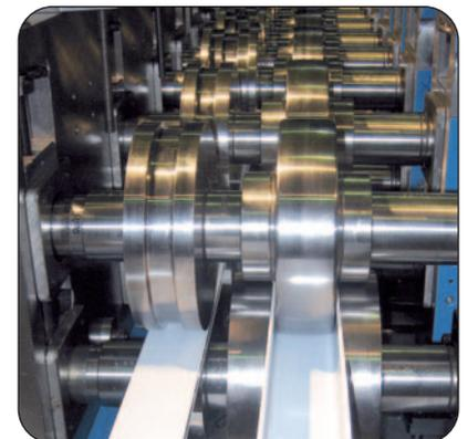
Profilage simultané de 2 pièces
