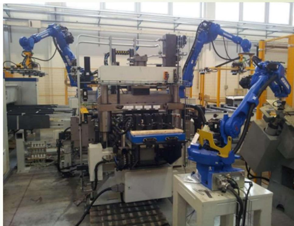
Ligne de fabrication de chemins de câbles filaires
